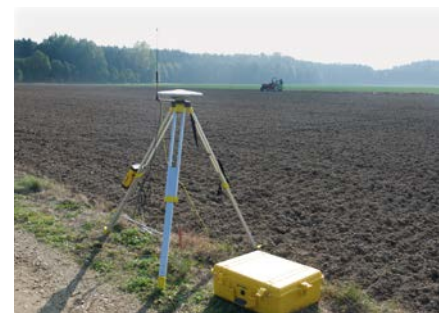
RTK-Station für höchste Präzision bei der Aussaat
