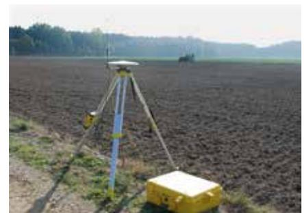
RTK-Station für höchste Präzision bei der Aussaat
